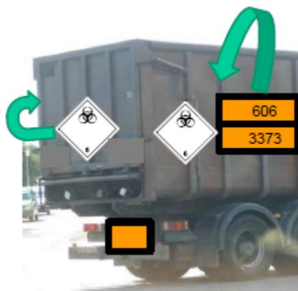
Abb. 2 Gefahrgutkennzeichnung des VTN-Fahrzeugs
